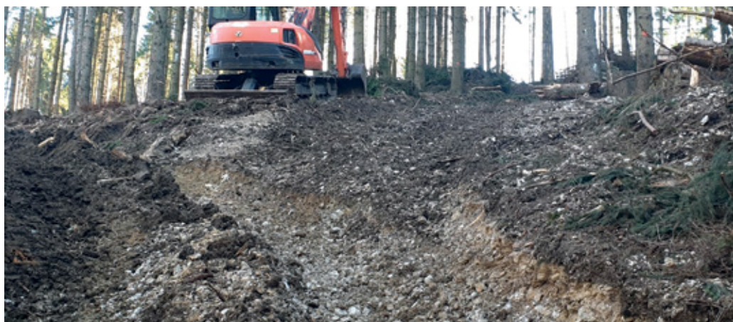
Un Forwarder e un esempio dei danni che produce al terreno
